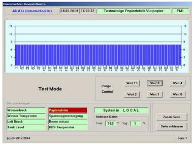
Kontrollmonitor der angeschlossenen Controller JDA48-1-X
